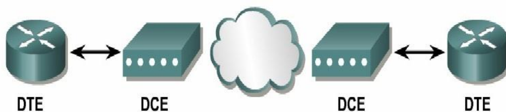
Gambar 5.8 Komponen DCE Pada Jaringan WAN
