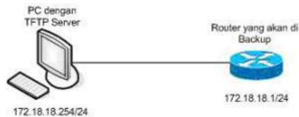
Gambar 1.10 Skema Koneksi PC Backup Dengan Router Yang Akan Dibackup
